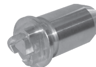
Feuerwehdreikant nach DIN 3222 zur Notentriegelung mit Feuerwehdreikantschlüssel. Nur für Notbedienung der Schranke geeignet. Einsatz für Selbst-Einbau.
